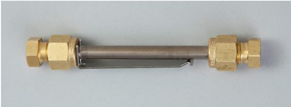
Abbildung 1: Thermodesorptionsröhrchen für die VOC-Probenahme, sogenannter PE-Sammler mit Tenax TA®.
