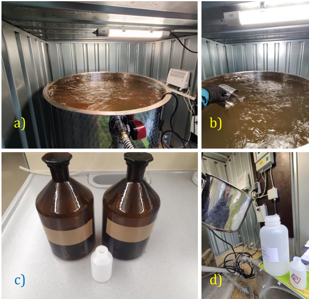
Abbildung 3: Entnahme der homogenisierten Mischproben an Feststoffsammlern
