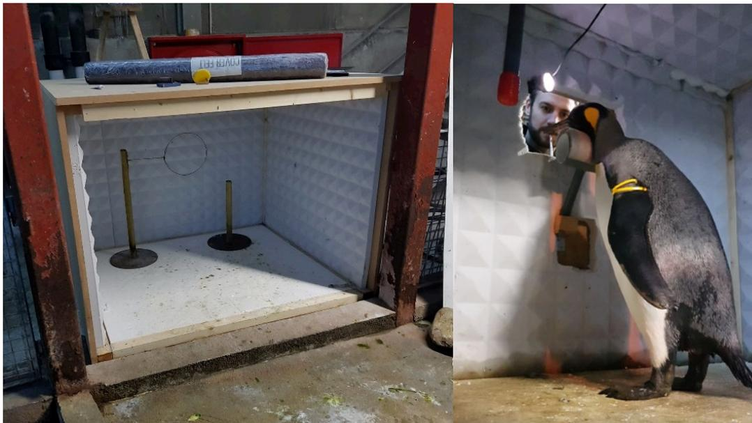
Links: Schalldichte Box mit offener Rückwand für die Audiometrie von Pinguinen. Rechts: Training eines Königspinguins in der Schallkammer im Zoo Odense. Quelle: eigene Darstellung, SDU
