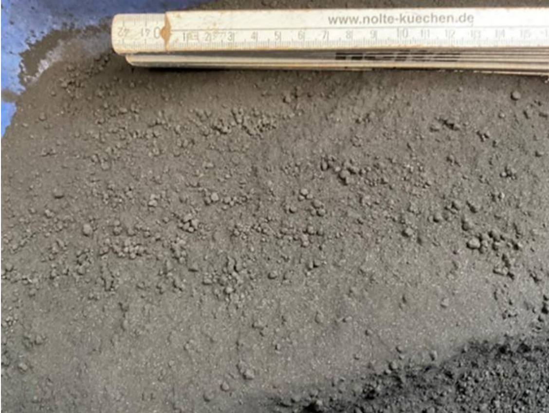
Abbildung 6: Fotografische Dokumentation zum Filterstaub (10 09 10) vom Gießen von Eisen und Stahl, Anlage A
