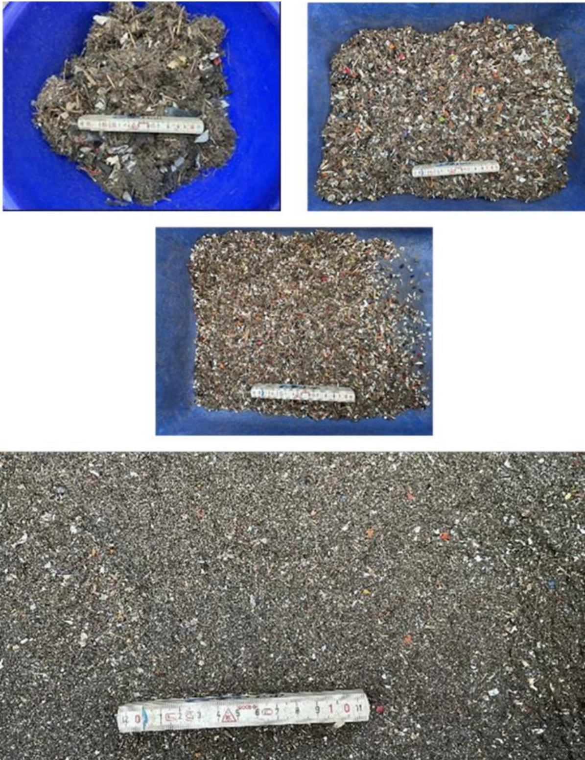
Oben links: >10 mm; oben rechts: 5 bis 10 mm, Mitte: 4 bis 5 mm, unten: Probe <4 mm Quelle: Eigene Darstellung, Stoffstromdesign, Ralf Ketelhut
