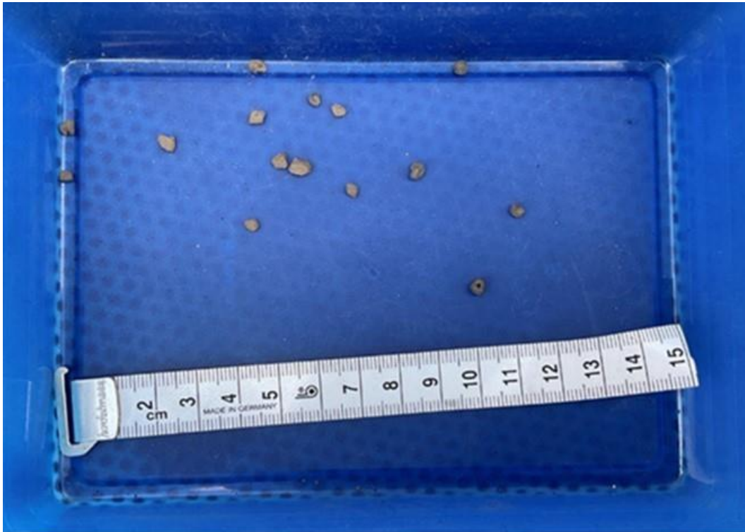
Abbildung 2: Fotografische Dokumentation zum Filterstaub (10 09 09*) vom Gießen von Eisen und Stahl, Charge 1 (Altmaterial, Lagerdauer >4 Wochen)
