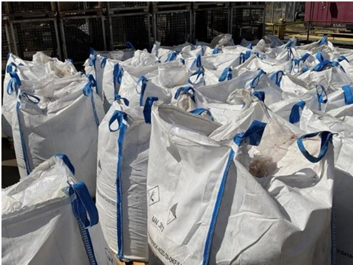
Abbildung 3: Fotografische Dokumentation zum Filterstaub (10 09 09*) vom Gießen von Eisen und Stahl, Charge 2 (Frischmaterial, Lagerdauer <4 Wochen)
