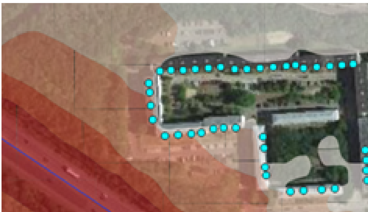
Abbildung 9: Beispiel für Gebäudepunkte und Lärmraster
