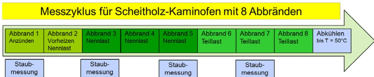
Die Feuerraumtür muss bei einer maximalen Nachlegezeit von 60 s unmittelbar nach dem Befüllen geschlossen werden. Weitere wichtige Kriterien für die Durchführung der beReal-Methode sind nachfolgend aufgelistet:
