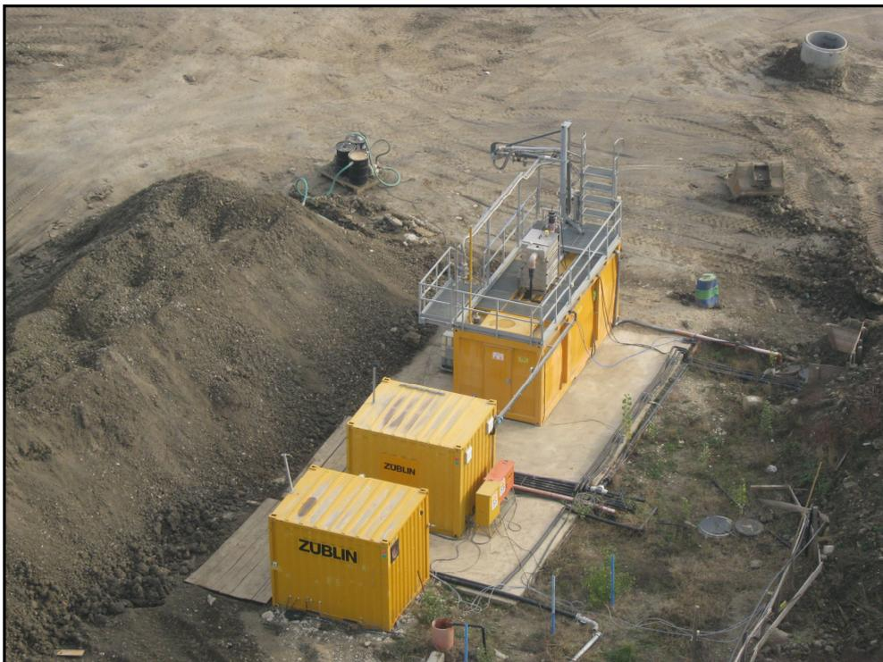
Foto 11: Anlage zur Ölabsaugung (zwei Container) und Übergabestation
