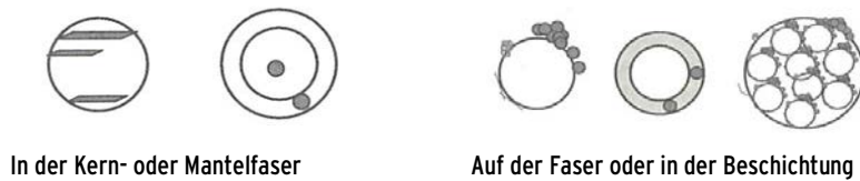
Abbildung 1: Möglichkeiten der Einbettung von Nanomaterialien in Textilien (nach Bickel und Som 2011)
