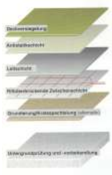
Beispiel des Aufbaus einer möglichen Abdichtfläche
