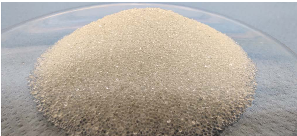
Abbildung 9: Glaskugeln („Glasbeads“). Quelle: Dirk P. Dygutsch.
