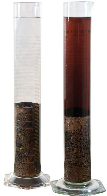
Abbildung 12: Ergebnis der Reinigung gebrauchter Filtrationsmaterialien mit Wasser (links) und speziellem Reinigungsmittel. Quelle: Dr. Nüsken Chemie GmbH.
