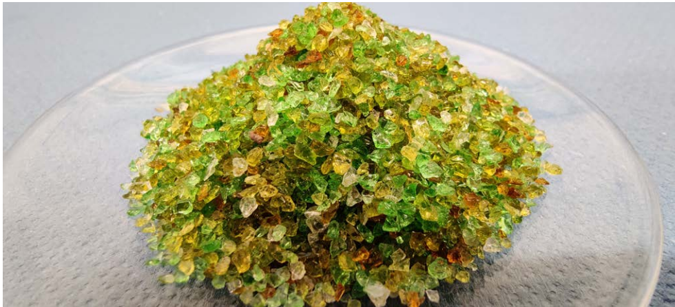
Abbildung 8: Glaskorn („Glasgranulat“, „Glasbruch“). Quelle: Dirk P. Dygutsch.
