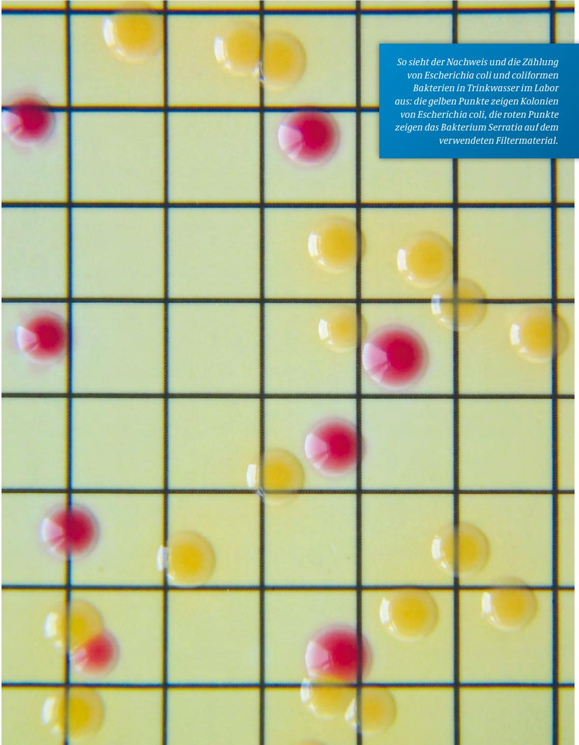
*So sieht der Nachweis und die Zählung von Escherichia coli und coliformen Bakterien in Trinkwasser im Labor aus: die gelben Punkte zeigen Kolonien von Escherichia coli, die roten Punkte zeigen das Bakterium Serratia auf dem verwendeten Filtermaterial.*
