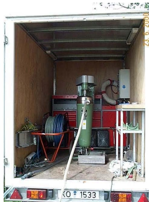
Abb. 3.1: Pkw-Anhänger mit mobiler Durchflusszentrifuge (DZ)
