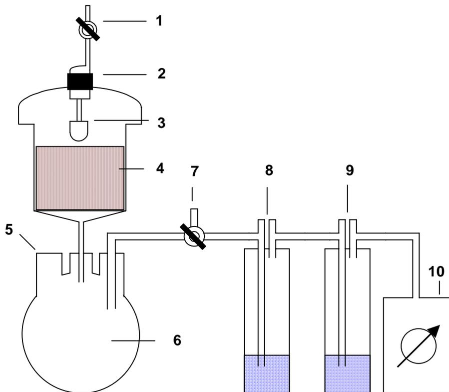
1: Ein-/Auslassventil, 2: Beregnungsöffnung, 3:  $^{14}\text{C}$ -Kohlendioxid-Absorptionsfalle (8 mL 0.1 M Kaliumhydroxid-Lösung) 4: Bodenkern (6 cm Höhe, 8.5 cm ID), 5: Perkolatentnahme, 6: Perkolatsammler, 7: Belüftungsventil, 8,9: Waschflasche, 10: Membranpumpe mit Manometer
