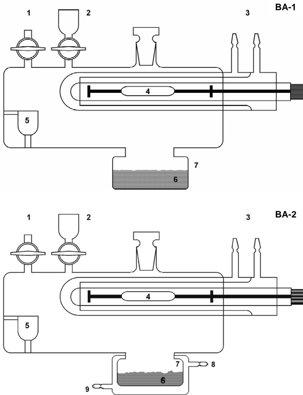
1: Einlassventil, 2: Auslass mit Aktivkohlefilter, 3: Wasser- bzw. Luftkühlung, 4: Quecksilber- bzw. Xenon-Strahler mit Pyrex®-Kühlmantel (cut off:  $\lambda = 290$  nm), 5: <sup>14</sup>C-Kohlendioxid-Absorptionsfalle (8 mL 0.1 M Kaliumhydroxid-Lösung), 6: Probe, 7: abnehmbarer Probenbehälter, 8,9: Wasserkühlung des Probenbehälters
