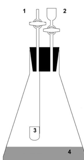
1: Einlassventil, 2: Auslassventil mit Aktivkohlefilter, 3:  $^{14}\text{C}$ -Kohlendioxid-Absorptionsfalle (8 mL 0.1 M Kaliumhydroxid-Lösung), 4: Probe
