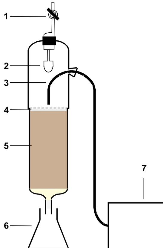
1: Ein-/Auslassventil, 2:  $^{14}\text{C}$ -Kohlendioxid-Absorptionsfalle (8 mL 0.1 M Kaliumhydroxid-Lösung), 3: Berechnungsschlauch, 4: Glasfritte, 5: Bodensäule, 6: Perkolatsammler, 7: Schlauchpumpe
