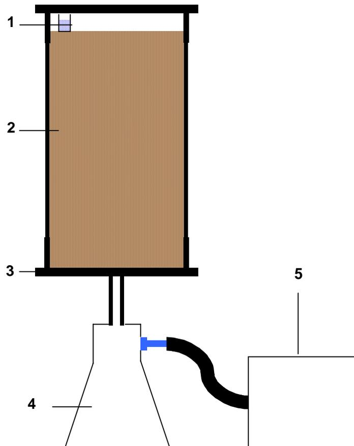
1:  $^{14}\text{C}$ -Kohlendioxid-Absorptionsfalle (8 mL 0.1 M Kaliumhydroxid-Lösung), 2: Bodenmonolith (30 cm Höhe, 15 cm ID), 3: Einsatz mit Ablaufrohr, Membran und Seesandfüllung, 4: Perkolatsammler, 5: Membranpumpe
