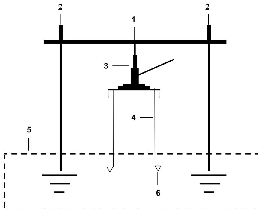
1: Drucktraverse, 2: Erdanker, 3: Hydraulikheber, 4: PVC-Rohr, 5: Bodenoberfläche, 6: Stechring
